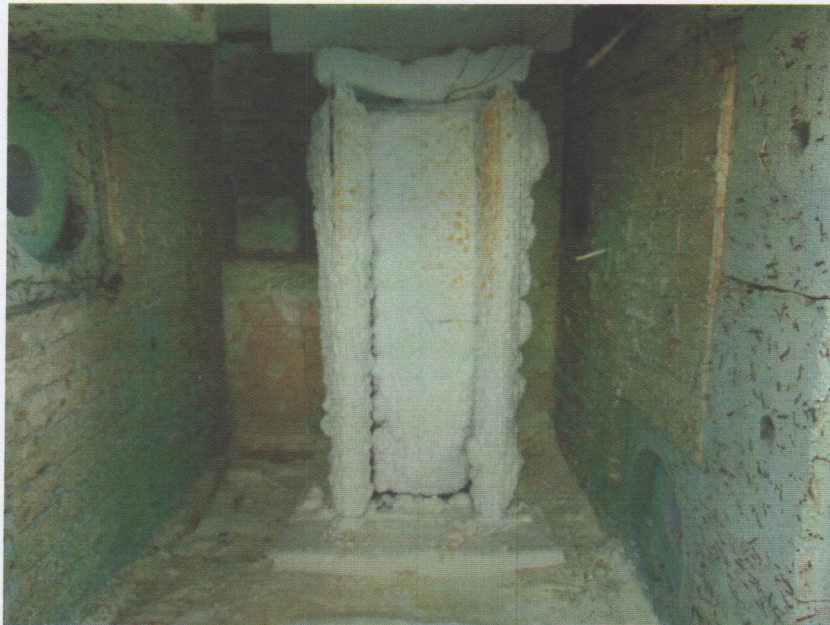
شکل ۲-۳: آزمون آتش یک ستون فولادی یک متری محافظت شده در مقابل حریق
