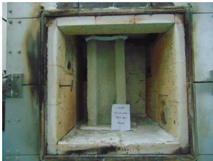
شکل ۱۰: آزمون آتش یک ستون فولادی یک متری محافظت شده در مقابل حریق
